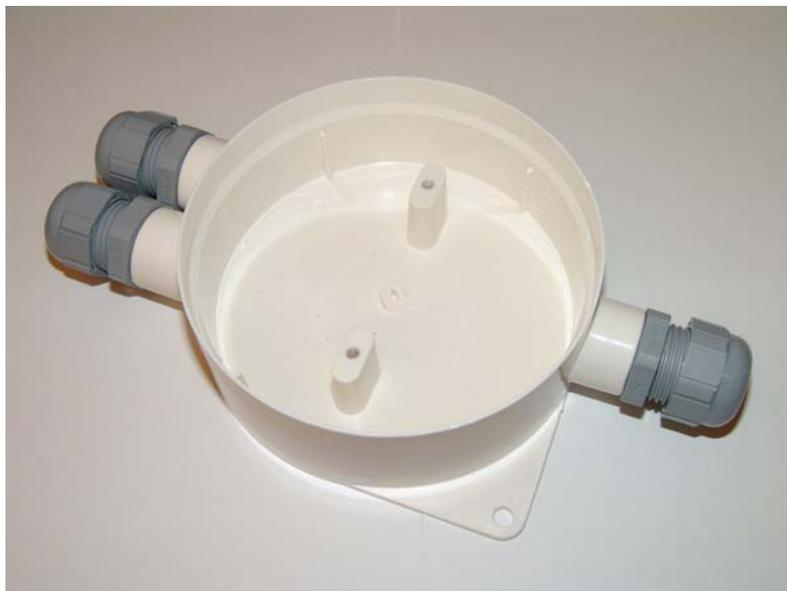
Dersom det er behov for detektorer i fuktige områder benyttes tett sokkel. Er det i tillegg kaldt eller mye kondens monteres det også varmeelement i sokkelen. Denne løsningen sikrer at det er mulig å bruke vanlige detektorer i kjølerom og utendørs. Benyttes varmeelement gjøres det sammen med en enkel termostat, dette for å hindre for høy temperatur når solen står på etc etc. Varmeelementet drives av 24 VDC. Boksene i seg selv har IP 67, mens detektorene har IP 43.
