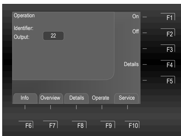
Fig. 66: Deaktivering av kontrollen 22 (eksempel)
