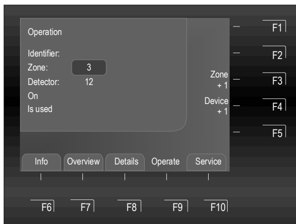
Fig. 43: Skjermen viser aktivering av sone 3 (eksempel)
