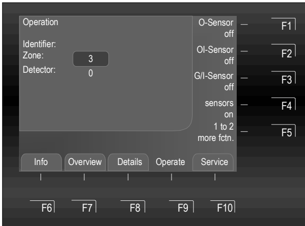
Fig. 52: Aktivere / Deaktivere sensorer (sløyfe) (eksempel)
