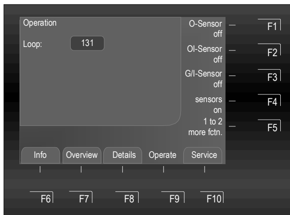
Fig. 80: Aktivere / Deaktivere sensorer (sløyfe) (eksempel)
