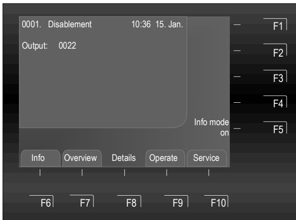
Fig. 69: Skjermen viser deaktivering av utgang 22
