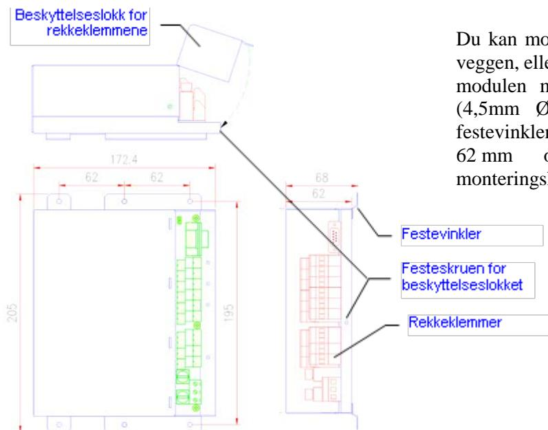
Du kan montere *Delta DA Quad* på veggen, eller inn i et skap, ved å feste modulen med seks egnede skruer (4,5mm Ø) gjennom hullene på festevinklene. Senteravstandene er 62 mm og 195 mm. Tilpass monteringshøyde etter behovet.
