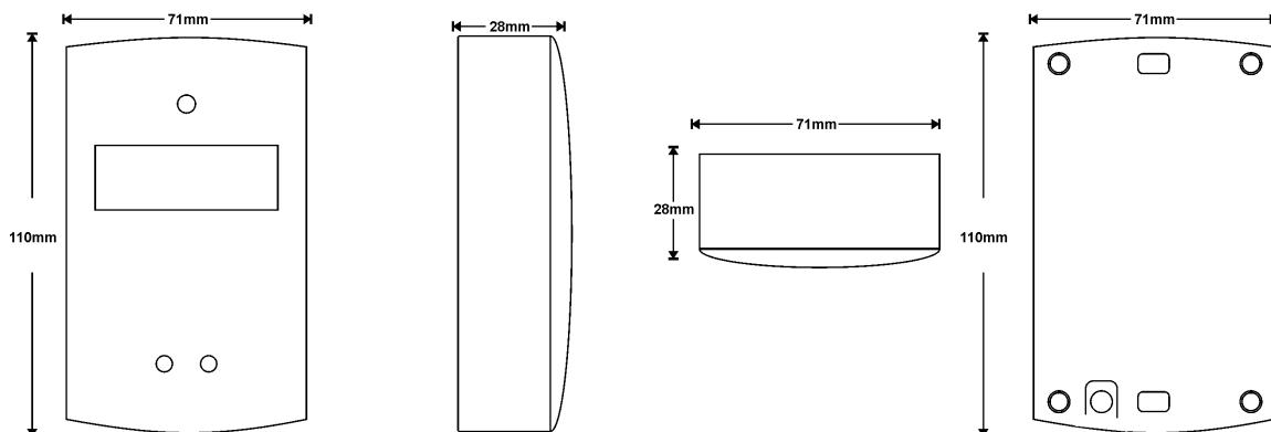
Denna handhålta enhet ger möjlighet att kontrollera den mottagna signalstyrkan (RSSI) på vilken position som helst i installationsytan, detta för att kunna optimera kvaliteten på kommunikationen i nätverket.
