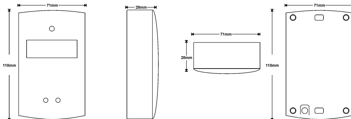
Tämä kädessäpidettävä laite mittaa signaalin voimakkuutta (RSSI) koko asennusalueella. Näin voidaan optimoida verkon toiminnan laatu.
